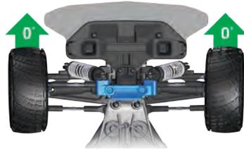
7. Maneje con suavidad el gatillo de velocidad para asegurarse de tener marcha adelante y marcha atrás y de que el motor se detiene cuando el gatillo de velocidad está en posición neutral. **ADVERTENCIA: No aplique aceleración total en marcha adelante o atrás mientras el modelo se encuentre elevado.**
