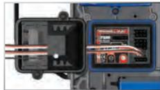
**Nota:** Para obtener un mejor rendimiento, se recomienda que se instale este receptor en la orientación original como se muestra.
